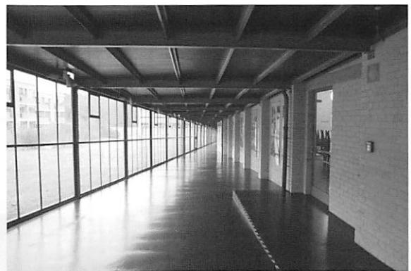
写真18 建物に設置された片廊下(ガラス張りにして廊下を付設温室とした)
